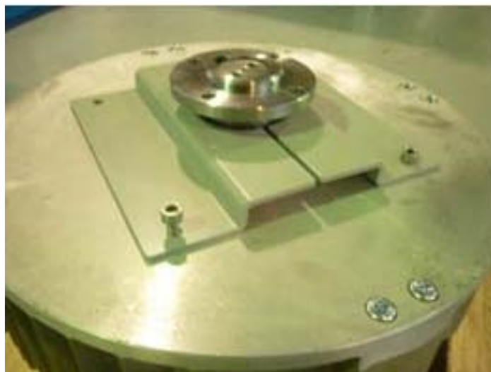
VIS M8x25 TCH INOX (déjà présente sur le moteur) ROND. GROWER D.8 (déjà présente sur le moteur)
